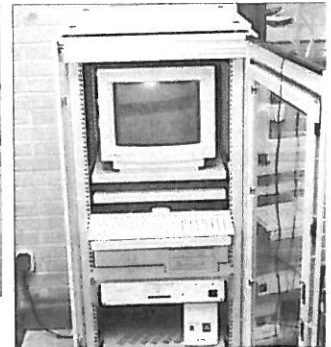
Opstelling van GPS-ontvanger, computer, voedingsapparatuur en modems, zoals opgesteld in de AGRS.NL-referentiestationen.
