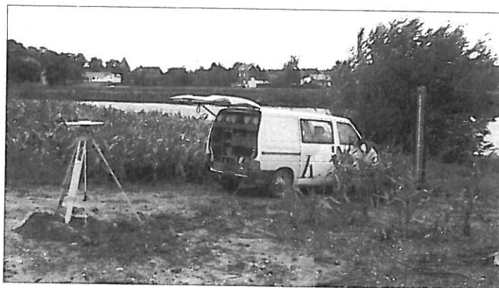
Stationaire GPS-ontvanger die als referentie fungeert voor de mobiele ontvanger. Deze ontvanger staat op een locatie met een exact bekende positie.
