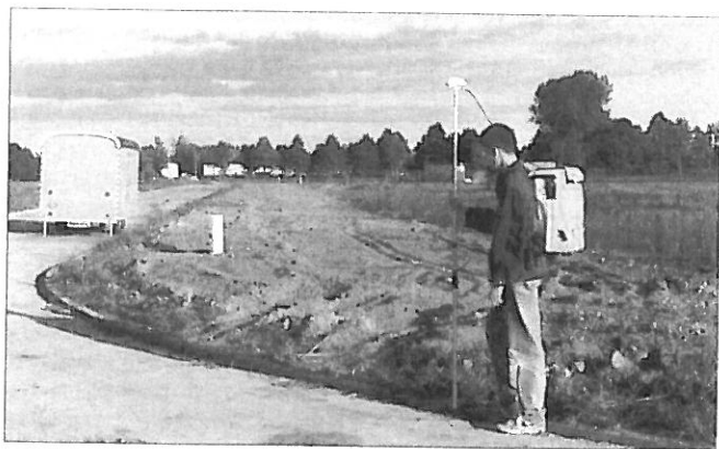
Landmeter met GPS-meetapparatuur tijdens het opmeten van een trottoirband. De positie van de mobiele ontvanger wordt bepaald ten opzichte van een referentie-ontvanger en gebruikt voor het vervaardigen van een digitale kaart.
