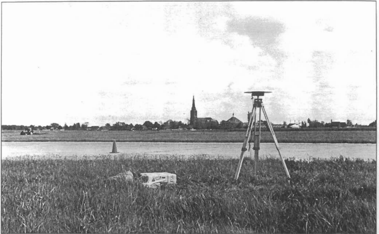
GPS-antenne op een statief tijdens metingen in het veld. Het doosje op de voorgrond bevat de GPS-ontvanger. De kerktoren op de achtergrond wordt daardoor overbodig als referentie voor meetkundige doeleinden.
